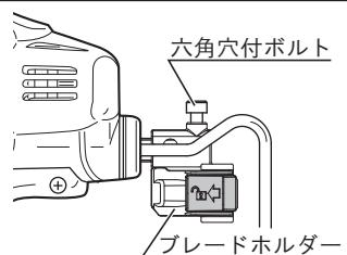
1. ブレードホルダーのレバーを矢印方向に押します。
