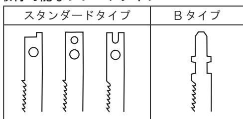
※ ジグソーブレードを取付けるときは、ブレードホルダーをジグソー刃用に交換する必要があります。
