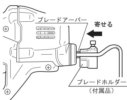
2. 付属品の六角棒レンチ（3mm）で、六角穴付ボルトをゆるめてブレードホルダーを取り外します。
