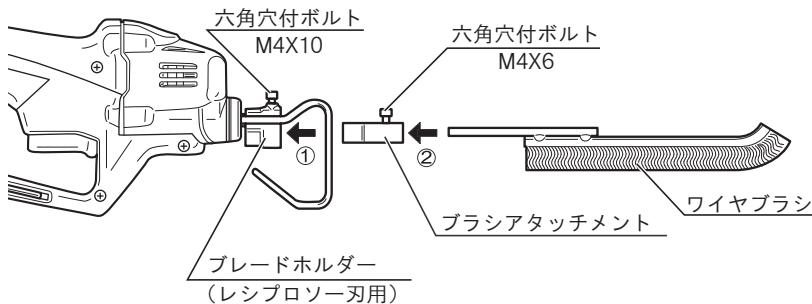
※ 六角穴付ボルトがブレードアーバーの凹部にはまる位置で締付けてください。
