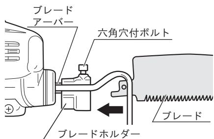
3. ブレードホルダーとブレードアーバーの先端を合わせ、六角穴付ボルトを六角棒レンチ（3mm）で締付けてください。
